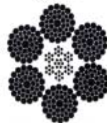
Cable de relleno Seale 6x49 con IWRC
